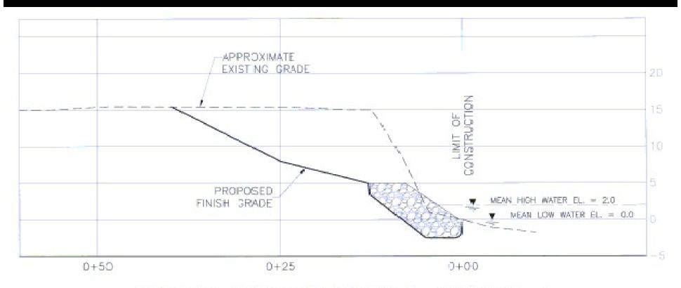
SEVERE EROSION TYPICAL SECTION A
